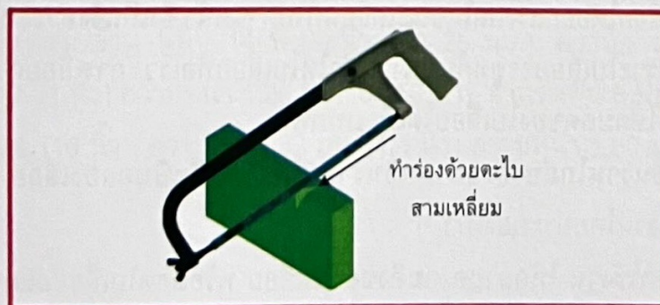
รูปที่ 6.8 ใช้ตะไบสามเหลี่ยมทำร่องนำก่อนเลื่อย
