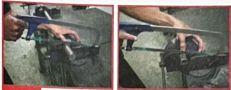
รูปที่ 6.5 การจับชิ้นงานให้จับใกล้ปากกาจับชิ้นงานมากที่สุด
