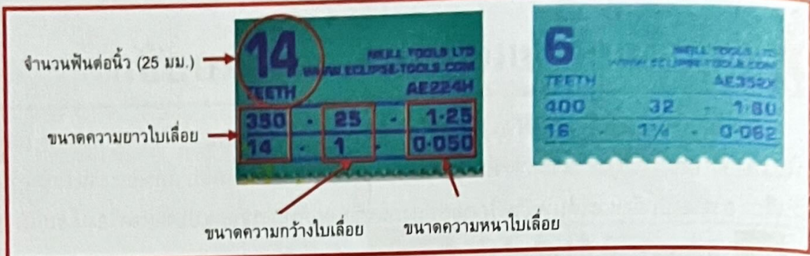
รูปที่ 6.13 การบอกค่าต่าง ๆ ของใบเลื่อยเครื่องกลแบบชัก
