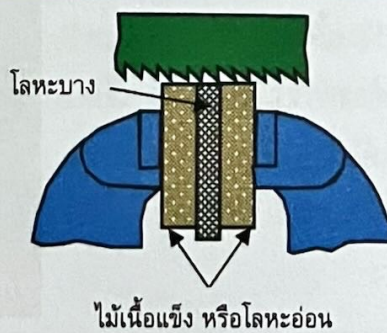
ข) ใช้ไม้หรือโลหะอ่อนประกบ 2 ด้าน
