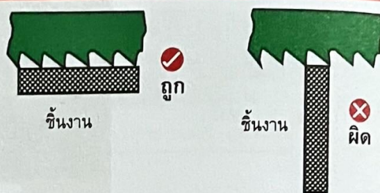
รูปที่ 6.10 ฟันของใบเลื่อยควรอยู่บนชิ้นงานอย่างน้อย 2-3 ฟัน
