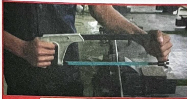
รูปที่ 6.6 การจับโครงเลื่อยเลื่อยชิ้นงาน
